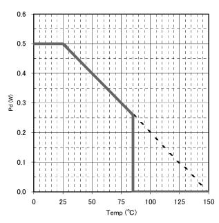
Fig. 1.2 BD8918FV/BD8919FV Power Dissipation
