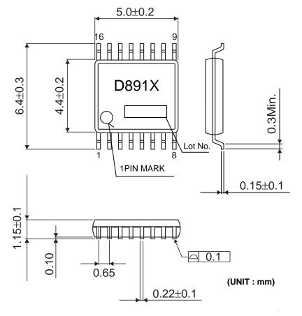
Fig. 3.2 SSOP-B16 Package Dimension
